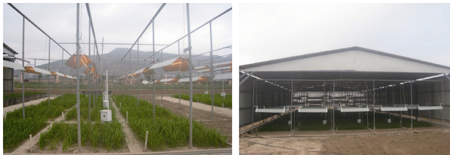
图2 试验基地增温装置和水分观测场
